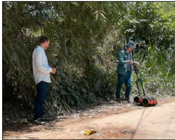
Figura 12. Validación de la información con equipo georadar en el distrito Barroblanco
